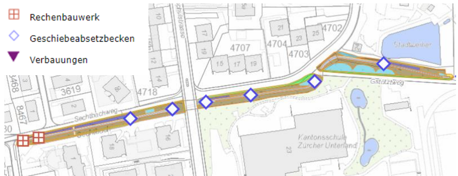
Abbildung 8 Rechenbauwerke und Geschiebesammler oberhalb Eindolung Innenstadt
