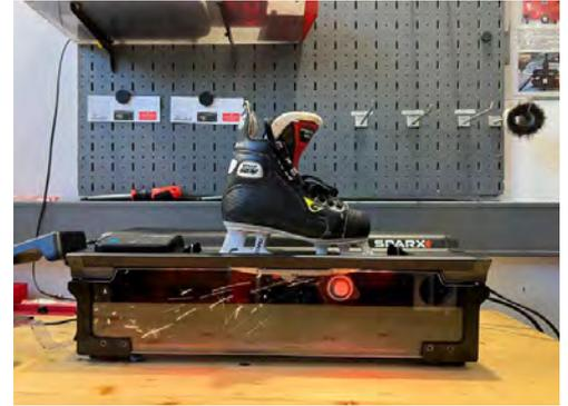
17 Präzision auf dem Eis: die neue Schlittschuhschleifmaschine SPARX im Einsatz
